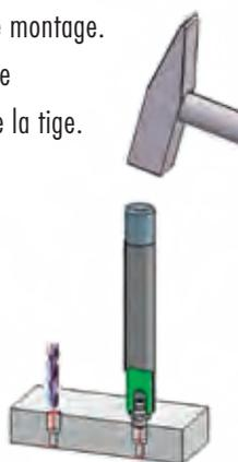
Les graisseurs à pose rapide seront utilisés avec un embout hydraulique.
