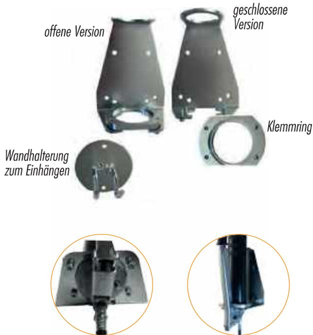
Mit der stabilen Wandhalterung aus verzinktem Stahl erhalten Sie eine stationäre Abschmierstation für Ihre UMETA-Fettpresse. Nach erfolgter Wandmontage der Halterung wird die Fettpresse mit dem Klemmring fixiert.
