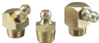
Гідравлічні прес-маслянки з самонарізною різьбою, Форма А, В, С (180°-45°-90°) Спеціально загартована поверхня для запобігання стиранню.
